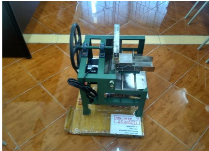
Gambar 2 , Mesin Pengiris Adonan Krupuk yang akan Didemonstrasikan
