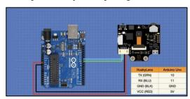
Gambar 10. Diagram Skematik *HuskyLens* dengan *Arduino*
