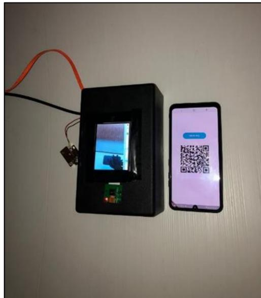
Gambar 8. *Prototype* dan Aplikasi *Quick Response (QR) Code* pada *Smart Key*
